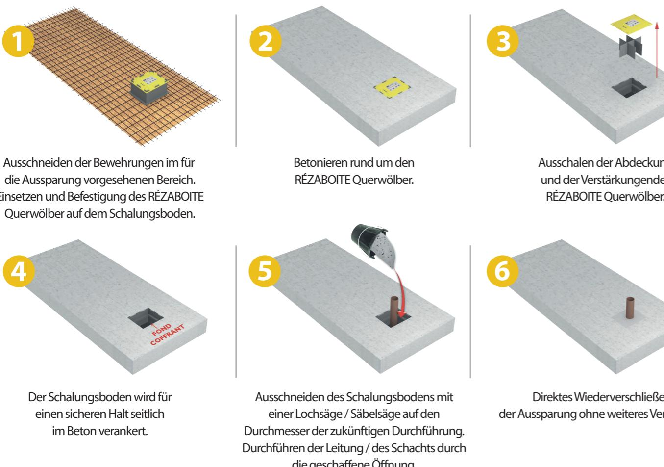
Ausschneiden der Bewehrungen im für die Aussparung vorgesehenen Bereich. Einsetzen und Befestigung des RÉZABOITE Querwölber auf dem Schalungsboden.
